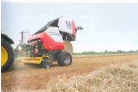
L'Impress 155 V en version Pro bénéficie d'un pick-up de 2,30 m de large et d'un système de coupe à 32 couteaux. Elle se décline également en finition Master avec ramasseur de 2,05 m et dispositif de coupe à 16 couteaux.
