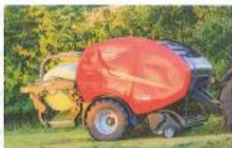
25 couteaux. Son mécanisme de liage utilise de base le filet et devrait à terme fonctionner également avec du film. L'unité d'enrubannage dispose, elle, de deux satellites et accepte des bobines de 750 mm de long. La FastBale
