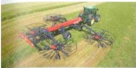
manœuvres en bout de champ. L'Andex 1254 présente une hauteur au transport de 4 m pouvant être abaissée à 3,45 m en retirant les bras porte-dents.
