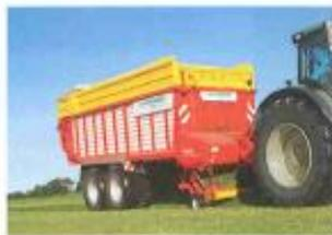
35 m<sup>3</sup> avec une simple porte arrière. Ce volume se voit réduit à 31 et 34 m<sup>3</sup> sur les modèles équipés des deux rouleaux doseurs arrière. Les Torro Combiline disposent d'un pick-up de 2 m de large et d'un système de coupe à
